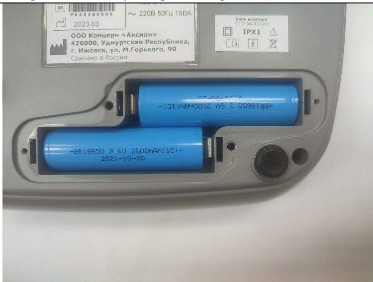
Рисунок 30 – Аккумуляторный отсек со снятой крышкой
